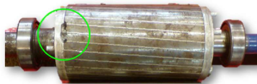
Figura 1 - Exemplo de rotor com três barras quebradas.
